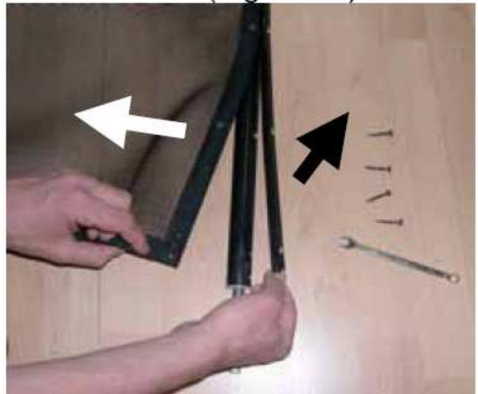
Figure 11. Dévisser les 10 vis de la réglette de fixation afin de libérer le filet
